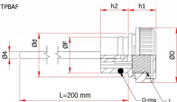
Tappo di riempimento a testa cilindrica e impugnatura zigrinata con asta di livello, ideale per applicazioni dov'è richiesto un ingombro ridotto. Montaggio a pressione su fori del diametro richiesto (tolleranza su foro  $\pm 0,1$  con smusso d'imbocco  $1/45^\circ$ ).
